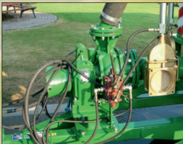
Michací čerpadlo nádrže ZK 50 na přání zákazníka.
